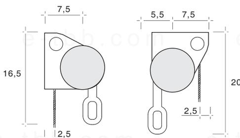
El mecanismo incluidos los soportes y el mando sobresale del tejido, según el sistema de accionamiento:
